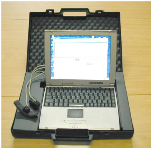
47.att. Divkanālu fotopletizmogāfijas ierīce ādas asins pulsāciju optiskai reģistrācijai (2002).
