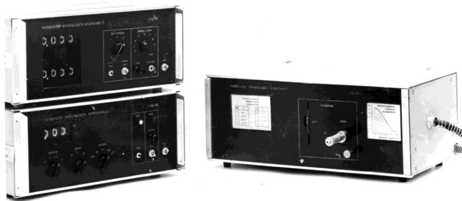
28.att. Mūsu līgumdarbā radītais kalibrētu impulsu starotājs (1983).
